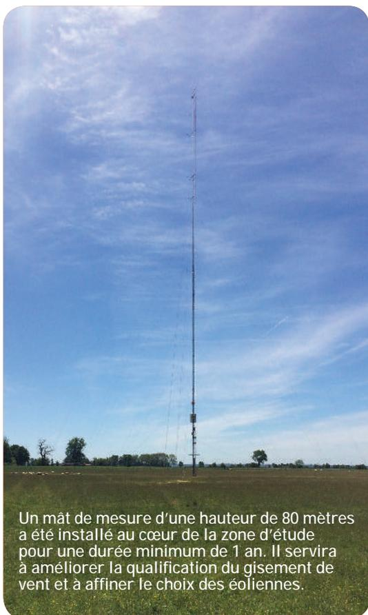
Un mât de mesure d'une hauteur de 80 mètres a été installé au cœur de la zone d'étude pour une durée minimum de 1 an. Il servira à améliorer la qualification du gisement de vent et à affiner le choix des éoliennes.
